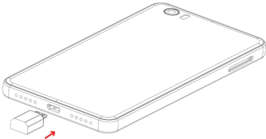
**Заряжать батарею можно с помощью зарядного устройства, или подключив смартфон к ПК через кабель USB.**
